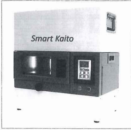
写真1 スマート解凍 100MHz電磁波を利用した最大出力50Wの解凍機。この周波数の特長は、表面から中心部までの温度むらがなく、均一な解凍が可能となることである。
